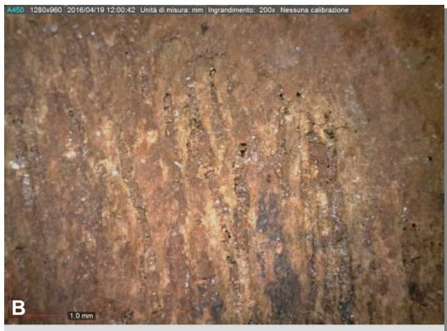
Immagini riprese con il microscopio portatile. **A**: sezione trasversale. **B**: sezione longitudinale. Si osservano vasi grandi (diametro circa 200 micron) con caratteristiche che riconducono alla **Paulownia**
