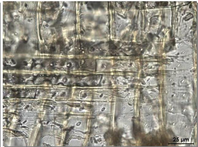
RAN RYOO, inv. N. 38463. Nella foto a sinistra punto di prelievo del campione A.15: taglio diretto di sezioni sottili tramite bisturi dalla lacuna sulla sommità della testa del drago. Nell'immagine al microscopio ottico della sezione radiale si osservano punteggiature dei campi di incrocio cupressoidi in numero di 2-3 per singolo campo. **Hinoki**
